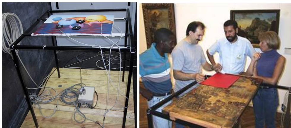
Figura 3: Ubicación de la Pintura, fuente de RX, sensores, placas y alineación de la fuente de Rayos X.
